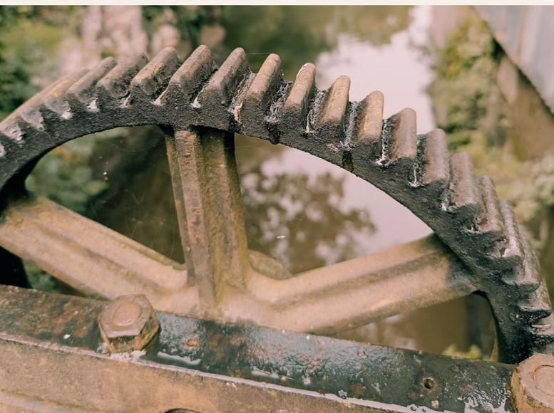
↑ Moulin des Mécaniciens, mécanisme d'une des vannes de contrôle du canal.
